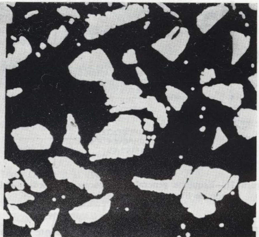
Figura 15.—Mejora de la imagen mediante un filtro para la medida de la superficie total de partículas.
