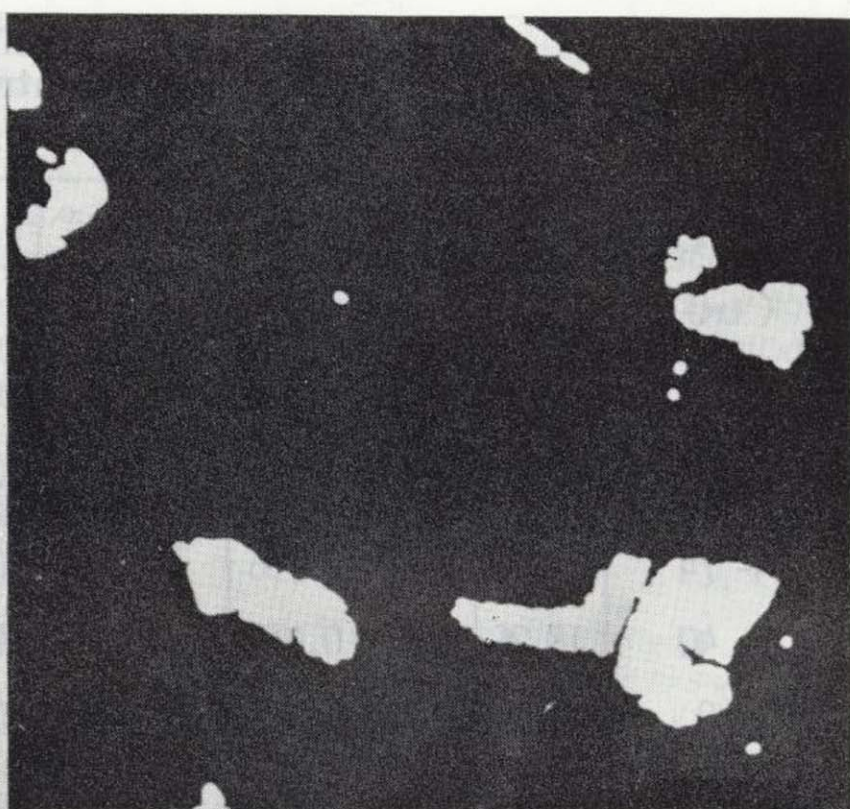
Figura 17.—Discriminación realizada para la determinación de la superficie total de partículas mixtas.
