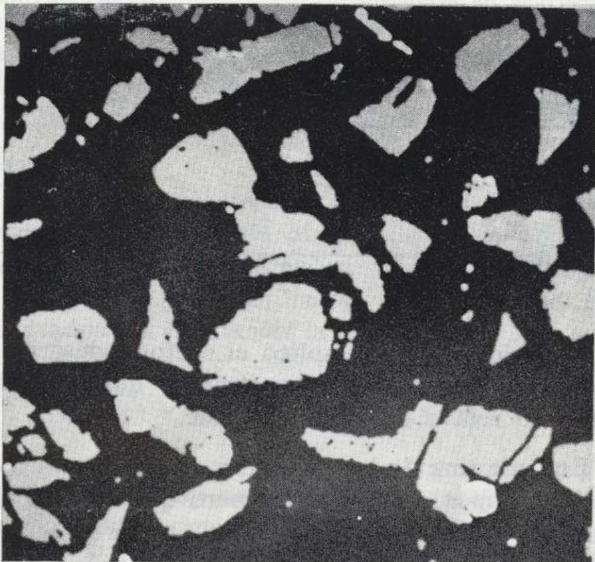
Figura 14.—Discriminación realizada para la medida de la superficie total de partículas.
