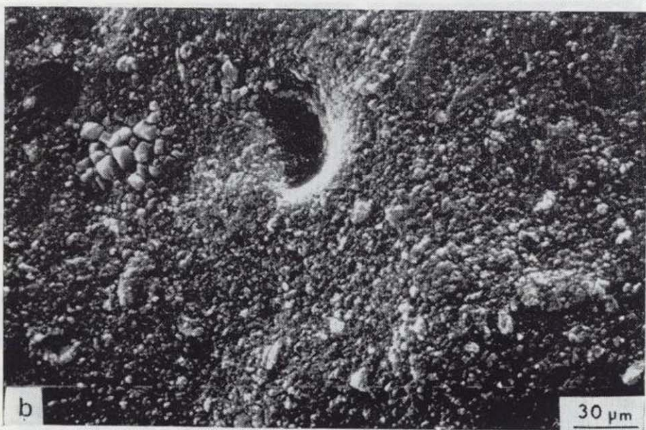
Figura 6.—Caliza de Laspra, variedad L-2. a) Micrita fosilífera removilizada, se observa algún grano de cuarzo y esparita (N. P.). b) Aspecto de los cristales de micrita, grabados por ácido (M. E. B., superficie atacada por ClH).
