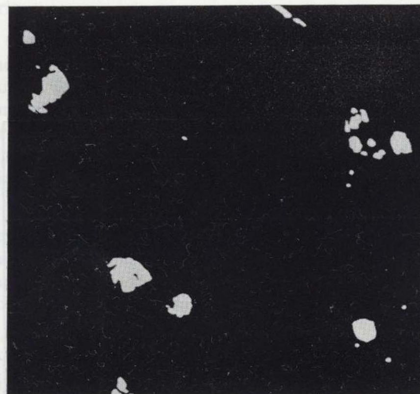
Figura 18.—Discriminación realizada para la medida de la superficie de galena en los mixtos.
